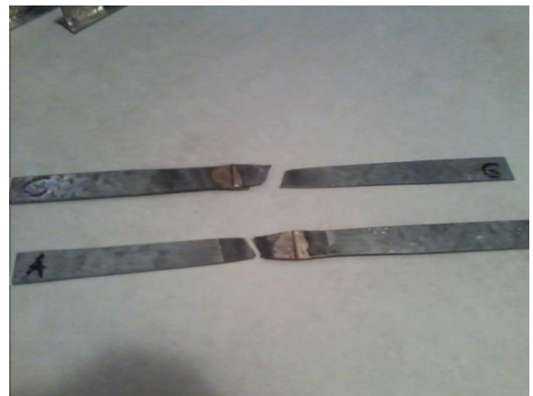
Fig. 5. Probe brazate după încercarea de rupere.
