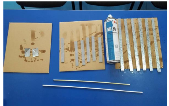
Fig. 2. Pregătirea probelor pentru brazare.
