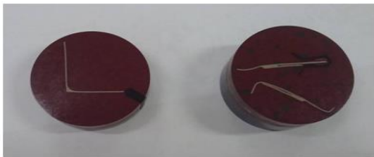
Fig 6. Probe înglobate în rășina fenolică.
